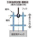
カットしたネットを図の様にチャックで固定し、引張 試験を行ない、その時の降伏点強さを測定する。
